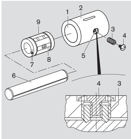
**⚠ Linearsets sind fertig montiert und spielfrei eingestellt. Wenn die Welle herausgezogen wurde, müssen die Stellschrauben gelockert und die Drehmoment-Kugelbüchse neu eingestellt werden.**
