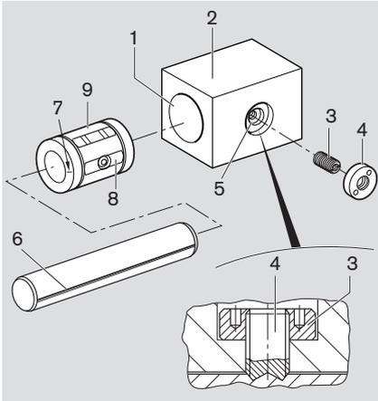
**⚠ Linearsets sind fertig montiert und spielfrei eingestellt. Wenn die Welle herausgezogen wurde, müssen die Stellschrauben gelockert und die Drehmoment-Kugelhülsen neu eingestellt werden.**
