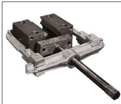
Alternativ kann die vormontierte Radial-Kugelbühse auch mit einer Abziehvorrichtung eingepresst werden. Das Druckstück muss in der Druckstange kugelgelagert sein (Pfeil). Ist dies nicht der Fall, muss ein Axiallager der Druckstange vorgesetzt werden, um ein Verdrehen der Radial-Kugelbühse im Gehäuse durch auftretende Drehmomente zu vermeiden.
