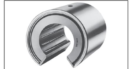
**Drehmoment-Kugelbüchsen** sind vollwertige Längsführungen mit nur einer Welle. Die Drehmomentübertragung erfolgt über tiefergesetzte Kugelumläufe.
