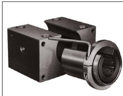
Montagering<sup>1)</sup> lt. Abbildung ansetzen und über Stellschraube die Radial-Kugelhülse soweit einengen, bis sie sich von Hand leicht in die Gehäusebohrung einschieben lässt. Die Bohrung des Montagerings muss um ca. 0,5 mm größer als der Außendurchmesser "D" der Radial-Kugelhülse sein.
