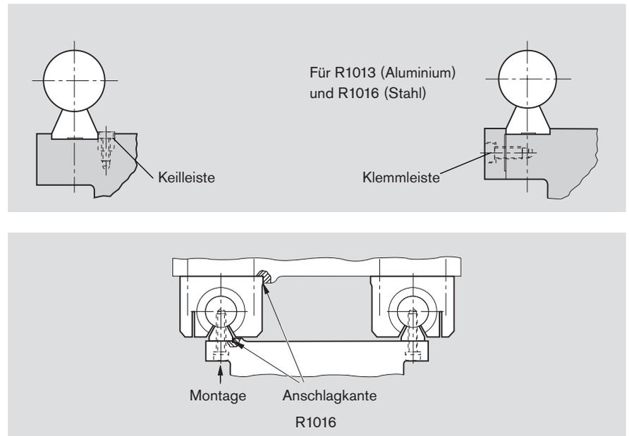
Die Wellenunterstützung muss bei der Montage gerade ausgerichtet werden. Hierzu ist die erste Welle mit Wellenunterstützung an die Anschlagkante anzupressen und zu verschrauben; anschließend die zweite Welle, vorzugsweise mit Leiste, ausrichten und verschrauben.
