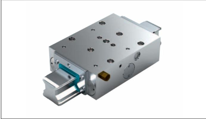
**Sehr hohe axiale Haltekräfte durch drei in Reihe geschaltete Kolben und starken Federenergiespeicher; Haltekrafterhöhung durch zusätzliche Luftbeaufschlagung am Plus-Luftanschluss.**
