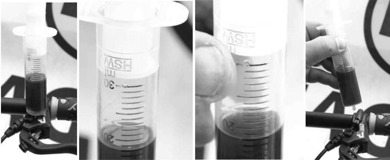
Ziehen Sie nun die Spritze **ÜBER** die Bohrung, damit wird das System Druckneutral. Verschließen Sie nun die Bohrung mit dem Finger und ziehen die Spritze aus der EBT Öffnung.
