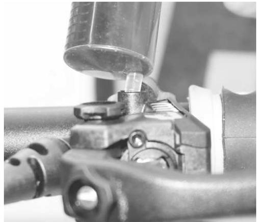
Entfernen Sie die EBT Schraube mit einem Torx T25.
