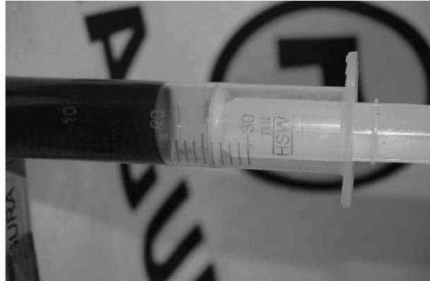
Befüllen Sie die Spritze bis zur 20 auf der Skala. Ziehen Sie anschließend weiter bis zur 25 auf der Skala, somit haben Sie ein Luftpolster von ca.5 Einheiten.
