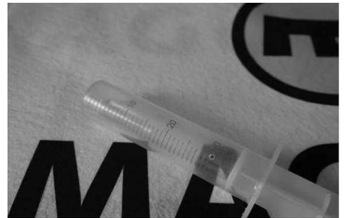
Bohren Sie an der Position 30 auf der Skala ein Loch mit einem 2mm Bohrer.
