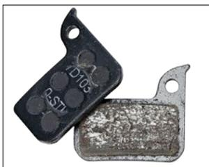
**Geruchsintensiv:** Die Beläge weisen nur geringe Gebrauchsspuren auf, rochen aber stark.
