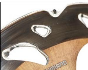
**Zu heiß:** Der Alukern der Scheibe wurde bei hoher Belastung weich – und dadurch herausgepresst.
