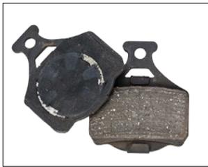
**Haltbar:** Die harten Bremsungen im Praxistest hinterließen an den Campa-Belägen kaum Spuren.
