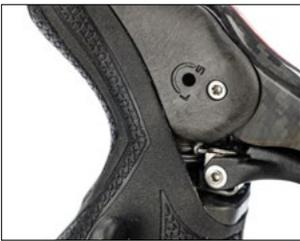
**Wahlfreiheit:** Am Hebel lassen sich per Inbus Druckpunkt und Charakter der Bremse variieren.
