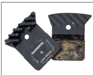
**Zu schnell weg:** Nach dem Praxistest waren Bremsbeläge und Trägerplatten völlig verschlissen.
