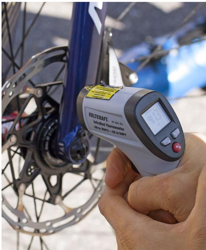
RoadBIKE ermittelte per Laserthermometer, wie heiß Brems Scheiben und -anlagen werden – und wie schnell sie wieder abkühlen.
