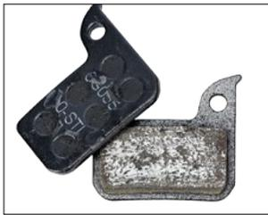
**Unbeeindruckt:** Die Bremsbeläge der Force zeigten trotz hoher Belastung kaum Verschleiß.
