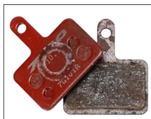
**Sichtbar belastet:** Die Beläge ziehen viele Späne aus der Disc und werden brüchig.
