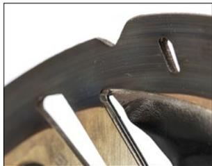
**Hitzewelle:** Die beim Bremsen auftretende Hitze hinterließ deutlich sichtbare Spuren.
