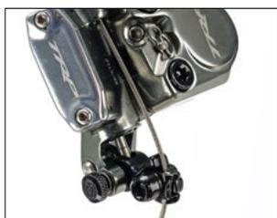
**Exotische Kombination:** Die Hydraulik wird über einen klassischen Bowdenzug angesteuert.
