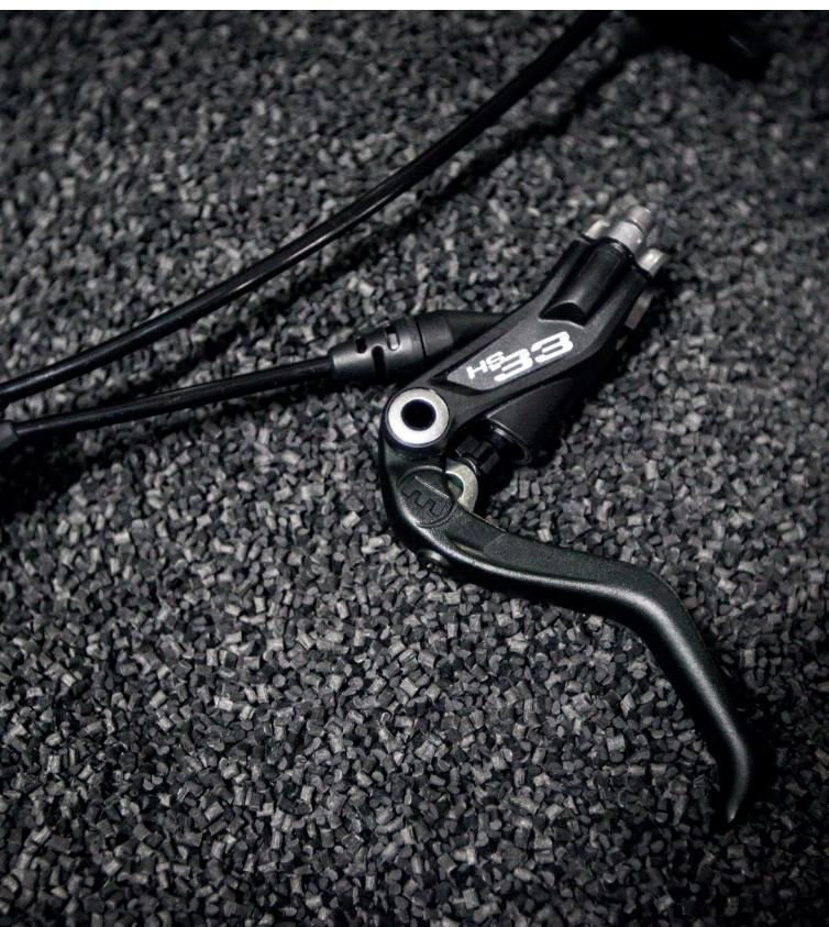
Dans le cas du **Carbotecture SL®**, nous augmentons la capacité de résistance tout en réduisant le poids, et ce, en intégrant au polyamide des fibres de carbone moyennement longues au lieu de fibres courtes. Les poignées de frein de notre série de freins à disque MT, vainqueurs de tests, se composent de Carbotecture® et de Carbotecture SL®.
